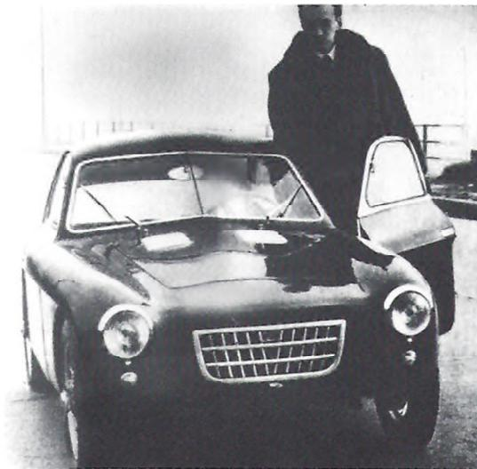
Aluminium-Aufbau, geteilte Frontscheibe und Front ohne Stoßstangen, der Giannini 750 Sport mit Frontmotor und Hinterradantrieb.
